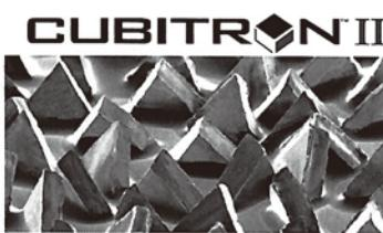
キュービトロン™II 研磨材製品は、規則的なトライアングル形状のセラミック砥粒を垂直配列。それぞれの砥粒はシャープエッジ形状を維持したまま消耗するように設計されており、常にナイフのような鋭い切っ先を保ちながら高い研磨性能を維持する。
