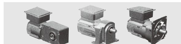
平行軸VXシリーズ、直交軸VCシリーズにプロテクトリレー付きが加わった。過負荷による機械装置の破損を未然に防ぎ、大切な機械装置を守る。特長は①過負荷変動による過電流を検知し、装置やギヤードモータの破損を防ぐ安全装置を搭載。②ディップスイッチにより、遮断電流・遮断時間設定ができる。(遮断電流:16段階、遮断時間:9段階)③マイコン制御により、高精度なリレー信号で過負荷を検知。温度変化にも強い信頼性を実現。過負荷検知誤差±3%。VXシリーズ:0.1~0.4kW(1/5~1/400)対応。VCシリーズ:0.1kW(1/7~1/240)、0.2kW(1/7~1/200)、0.4kW(1/7~1/160)対応。
