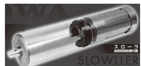
傾斜ローラコンベヤにおいて搬送物がスローラの上を通過することによるローラの回転が内部ギヤを增速させ、遠心ブレーキが作動するしくみの速度制御装置を内蔵している。
