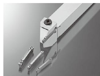
GND型はホルダ材質に高剛性の特殊鋼を採用、チップ固定部からシャンクまでを一体構造とし、加工中に発生する振動を従来品比で最大30%低減。通常の溝入れ加工に加え、横送り加工、プロファイ尔加工、突切り加工を可能にする工具である。
