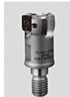
・立壁の急勾配曲面を工具外周の大きなR切れ刃部により、大きな加工ピッチで加工するため、1回の加工で広い面積を加工することができ、従来のラジアス(ボール)エンドミルよりも大幅に高能率で加工可能である。また、加工ピッチが大きくなり、切削経路長が短くなることで工具寿命も向上する。
