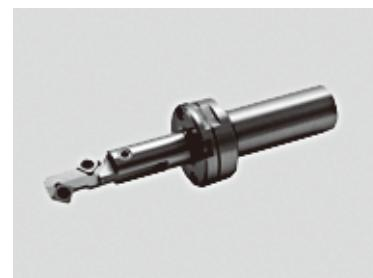
ためのバリ取り工具である。チルト機構式の正逆回転でバリを取りことを特徴とし、複雑な開口形状に発生するバリの完成除去を狙って開発した。機械側の動きも回転と軸方向の動きのみで使用でき、汎用化にも対応している。
