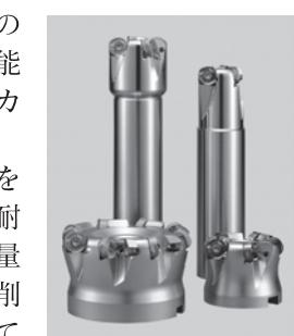
近年、エネルギー産業を中心にステンレス鋼や超耐熱合金等の難削材の使用量が増加してきている。難削材のミリング加工においては、ラジアスカッタが使用されるケースが多いが、工具寿命の改善が課題であった。M R W型は「両面八コーナー仕様」、「ヘリカル切れ刃設計」および「切り込み量に応じた最適切れ刃設計」の採用により、従来のラジアスカッタの課題を解決し、難削材加工の生産性向上に貢献する。
