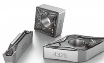
GC4325に代表されるGC4300シリーズは、革新的コーティング技術であるInveio™(インヴェイオ)コーティングを採用した、次世代の鋼旋削用材種である。アルミナ結晶を一方向に揃える技術により、コーティングの強度と耐熱性を飛躍的に高めている。さらに刃先処理精度向上による寿命のばらつき低減や、幅広い適用範囲によるチップ在庫の削減など、鋼加工の生産性を飛躍的に増加させる製品である。
