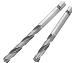
新製品ステンレス用油穴付き超硬ドリル『WDO-SUS-3D/5D』は、これらのトラブルを解決。切りくずを細かく分断する新型溝形状を採用。被削材と摩擦する面積が減少し、マージン部で発生する摩擦熱を低減する特殊マージン形状を採用。大きなバックテーパ、クーラント排出量が増大し、切りくず排出性を向上させ切削熱を素早く除去する新型オイルホール形状『MEGA COOLER』を採用している。
