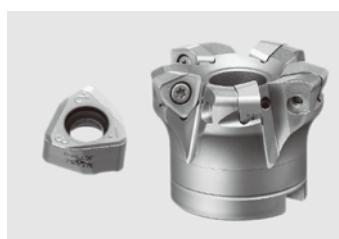
従来製品の高送り用刃先交換式チップの切れ刃を長く且つ高剛性とし、加えてすくい角を大きくすることにより、高切り込みができ、大幅な切り屑排出量の向上を実現させた。
