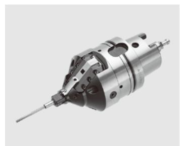
対応としてプランジ式が大半を占めていた。今回、トラバース式でMC対応を図り、設備の汎用機化と多品種ワークの混流生産化を狙った。対応設備はU軸を搭載したMCであり、U軸単軸でバルブシートのシート面仕上げ加工とバルブガイド穴のリーマ加工を連続して行うことが可能である。
