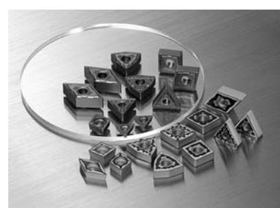
その対応のため、当社は新CVDコーティング技術「Absotech Platinum」を適用した「AC6030M」、新PVDコーティング技術「Absotech Bronze」を適用した「AC6040M」と粗切削用ブレーカ「EM型」を開発した。「AC6030M」は高い耐摩耗性と耐チッピング性を有する一般加工用材種で、「AC6040M」は優れた耐欠損性を有する断続加工用材種である。
