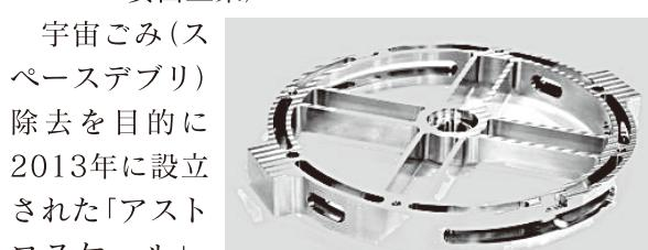
宇宙ごみ(スペースデブリ)除去を目的に2013年に設立された「アストロスケール」。同社が来年初頭に打ち上げを予定するデブリ観測用人工衛星「IDEA(イデア)OSG 1」の最新部品(アダプター=ロケットと人工衛星の結合部品)を、5軸マシニングセンタで加工。
